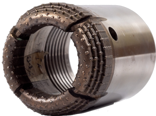
TI 215. Алмазная коронка ССК 59 1 для работы со съемным керноприемником. Из коллекции Горного музея.
