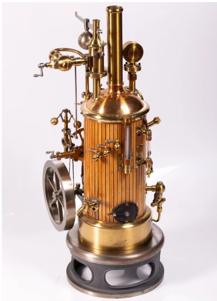
Паровая машина с котлом вертикального типа. Механическая мастерская Петермана. Санкт-Петербург. Модель. Из коллекции Горного музея.
