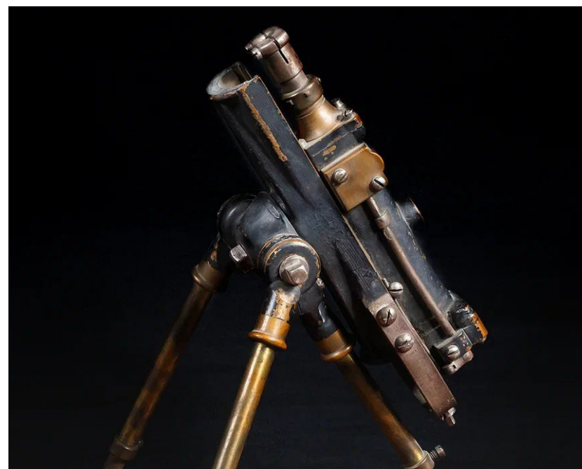
Электрический перфоратор соленоидной системы. Фирма Union Rock Drill. США. 1870-е гг. Один из первых в мире электроперфораторов. Масштаб 1:6. Дар горного инженера Л. Никольского. Из коллекции Горного музея.
