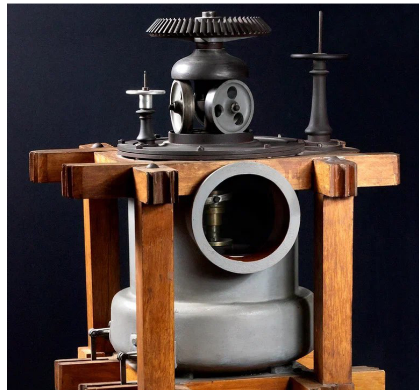
Гидравлическая турбина высокого давления конструкции профессора И. А. Тиме. Диплом Всемирной Венской выставки 1873 года. Модель. Мастерская Ф. Элери. Санкт-Петербург. Дар профессора И.А. Тиме. Из коллекции Горного музея.
