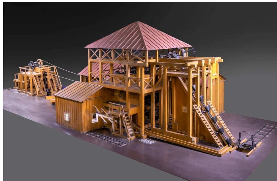
Рис. 4. TI 144. Модель золотопромывочной фабрики Миасского золотопромышленного товарищества
