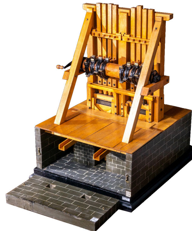
Модель толчеи с двумя ставами. Гейер, 1870 г. Из коллекции Горного музея.
