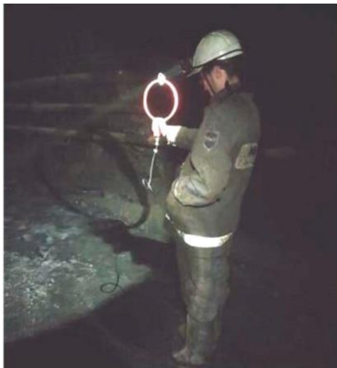
Рис. 1. Использование прибора «Ангел-М» для измерения ЭИВР в Норильском подземном руднике
