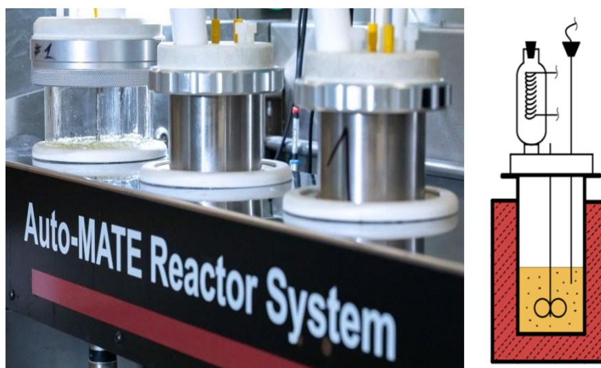
Рис. 6. Реактор идеального смешения, использованный для синтеза (Auto-MATE Reactor System H.E.L)
