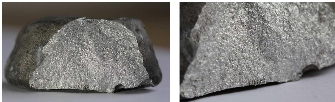
Рис. 4. Макроструктура лигатуры Mg-Zn-Y: (a) 5×; (b) 5,5×
