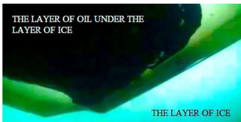
Рис. 9. Изображение нефти под слоем льда (вид снизу) [66]
