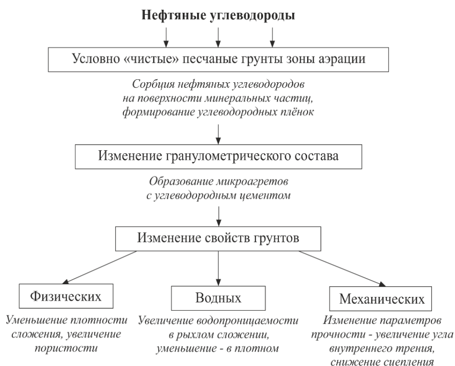
Рис. 9. Схема трансформации песчаного грунта при длительном углеводородном загрязнении
