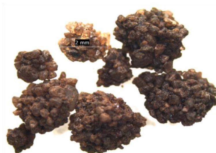
Рис. 3. Микроагрегаты частиц песка, загрязненного нефтяными углеводородами (изображение получено с помощью микроскопа LEICA DM750)
