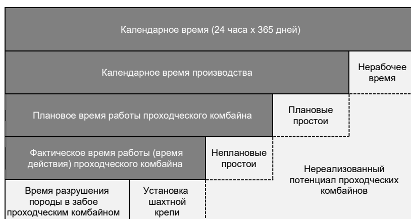
Рис. 3. Структура времени работы и простоя горных комбайнов
