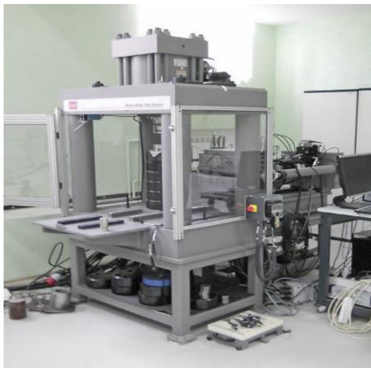
Рис. 2: Экспериментальная система для механики горных пород MTS816
