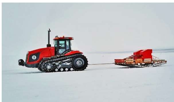
Рис.3. Фрагмент уплотнения снежного слоя с помощью уплотняющей платформы (а) и автомобиль-кран, используемый в качестве тестовой тележки для проверки прочности покрытия аэродрома (б)
