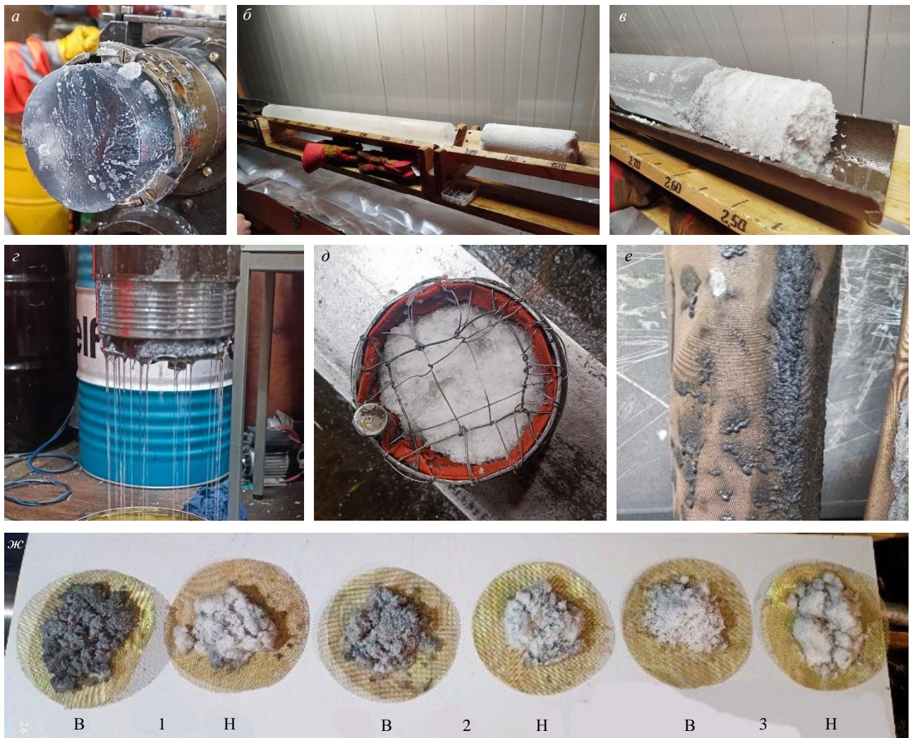
Рис.6. Результаты экспериментального бурения: керн в колонковой трубе после извлечения бурового снаряда из скважины (а); керн и шламовая пробка рейса № 22 (б); рейса № 23 (в); истечение ЗЖ из шламособорного отсека в ходе разборки бурового снаряда после рейса № 22 (з); забитый шламом обратный клапан (д); нижний фильтр после рейса № 22 (е); пробы шлама (ж)
