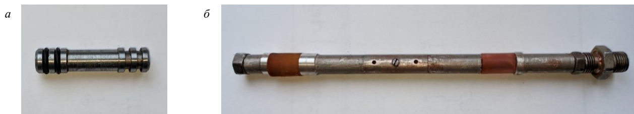
Рис.2. Герметизатор для изолирования наклонной скважины (а) и двухпакерное устройство (б)
