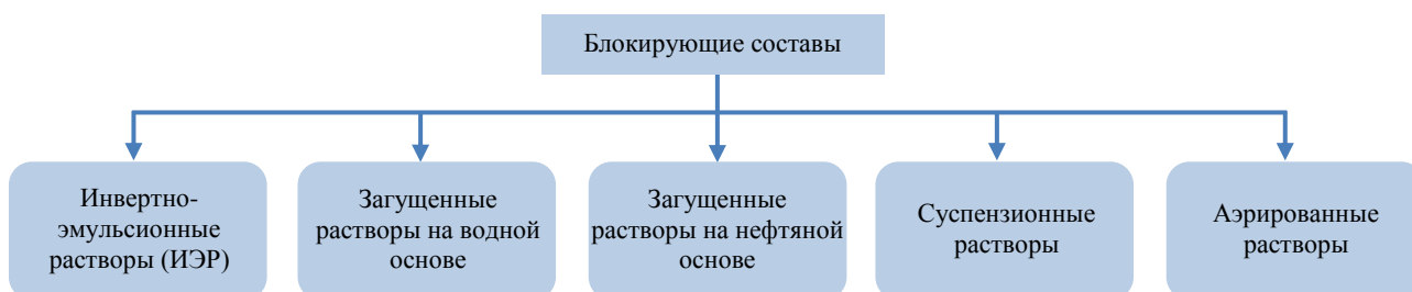
Рис.1. Основные типы блокирующих составов глушения
