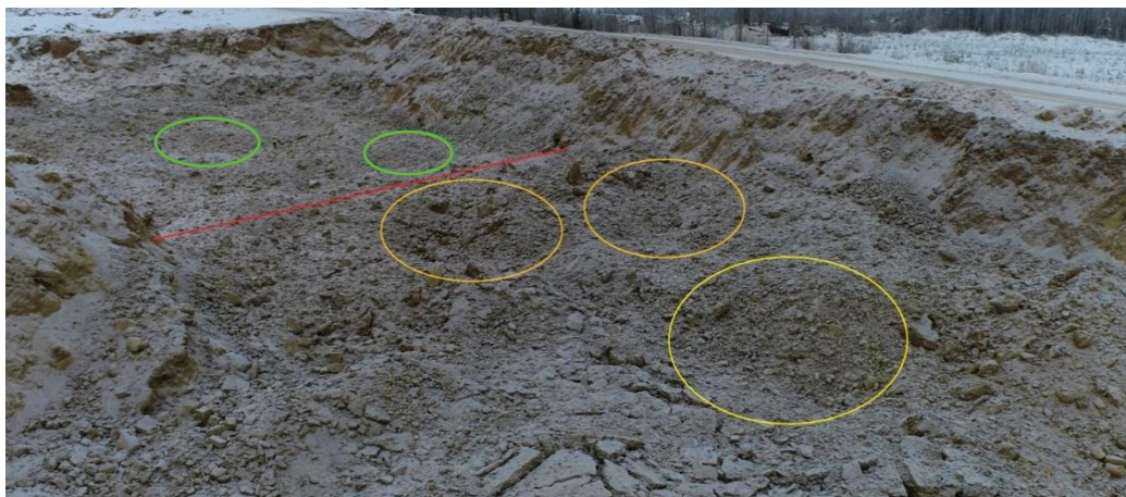
Рис.5. Результаты проведения буровзрывных работ на экспериментальном блоке (желтым цветом выделены воронки на участке блока со стандартными параметрами, зеленым – с экспериментальными)
