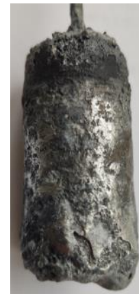
Рис.3. Образцы композита после электролиза: а – C-TiC; б – C-TiB 2
