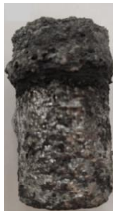
Рис.3. Образцы композита после электролиза: а – C-TiC; б – C-TiB 2
