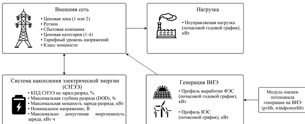
Рис.1. Структурная схема имитационной модели гибридной системы электроснабжения
