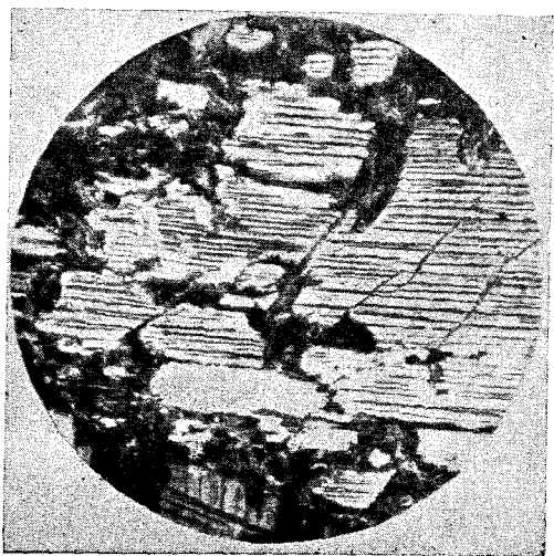
Рис. 10. Сподумен, замещаемый минералами группы каолинита. Sp—сподумен. X 45. Без анализатора
