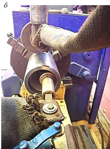
Рис.7. Фрагменты электромеханической обработки резьбы ниппеля (а) и муфты (б) переводника
