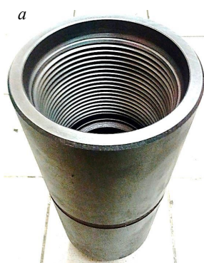
Рис.8. Фрагмент муфтовой (а) и ниппельной (б) частей переводников производства ООО «ПТФ НИГМАШ» П-133/133 – 3 шт., П-147/147 – 3 шт. после электромеханической обработки резьбы
