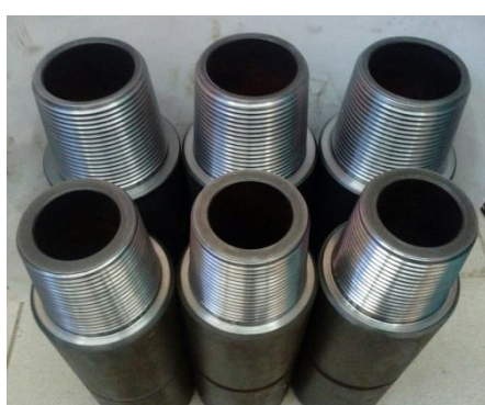
Рис.8. Фрагмент муфтовой (а) и ниппельной (б) частей переводников производства ООО «ПТФ НИГМАШ» П-133/133 – 3 шт., П-147/147 – 3 шт. после электромеханической обработки резьбы
