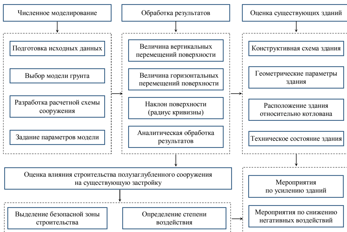
Рис. 1. Алгоритм расчета полузаглубленных подземных сооружений
