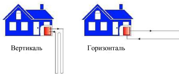
Рис.2. Схема «закрытая петля» для ГТНУ
