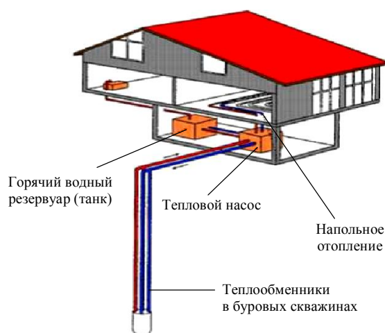
Рис.5. Типичное применение домашней системы теплоснабжения с геотермальным тепловым насосом в Центральной Европе (глубина скважин \geq 100 м)
