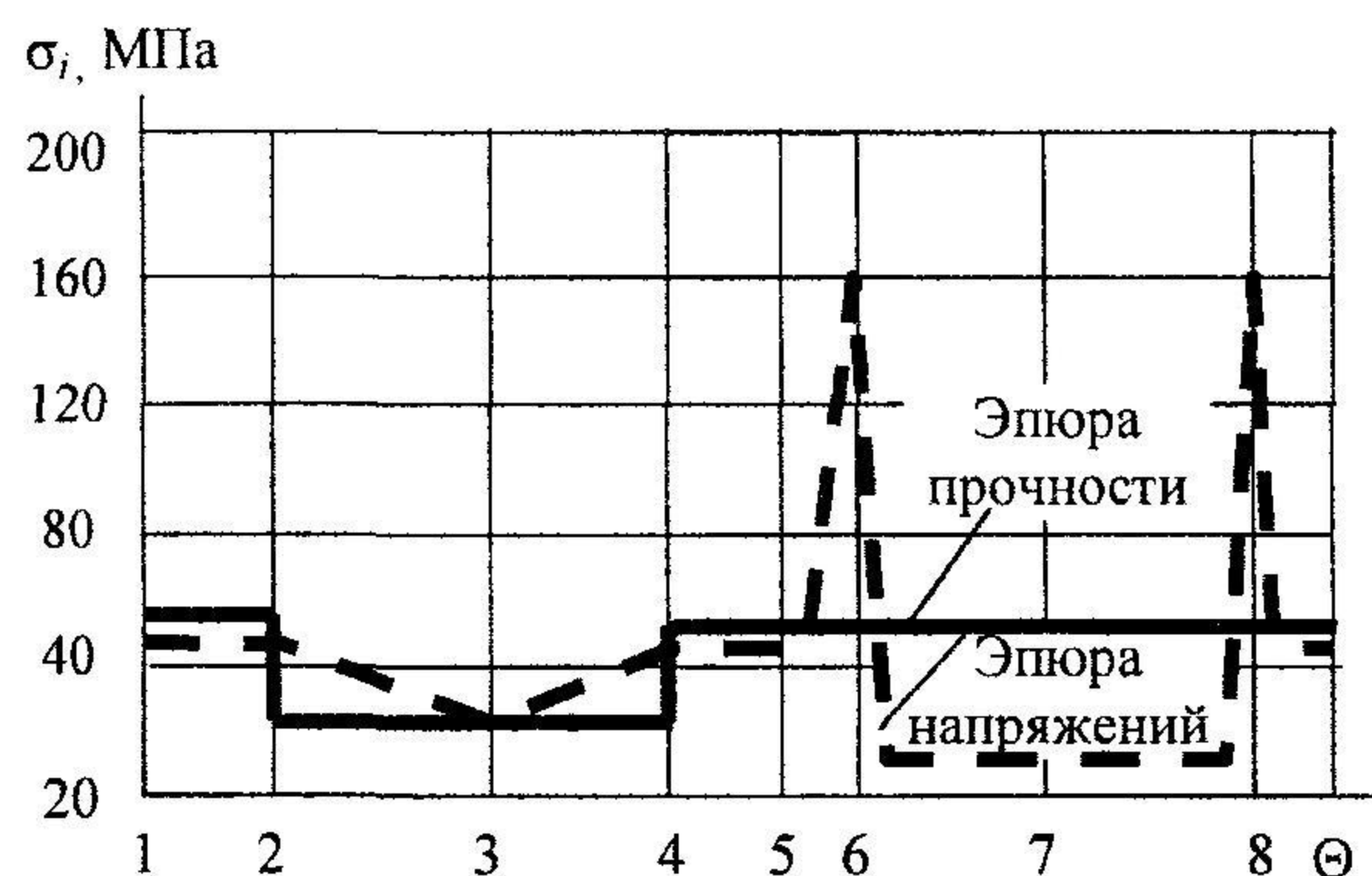
Рис.3. Паспорт прочности контуров выработки
