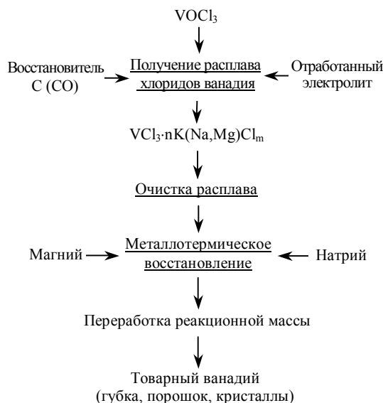
Рис.1. Технологическая схема получения ванадия
