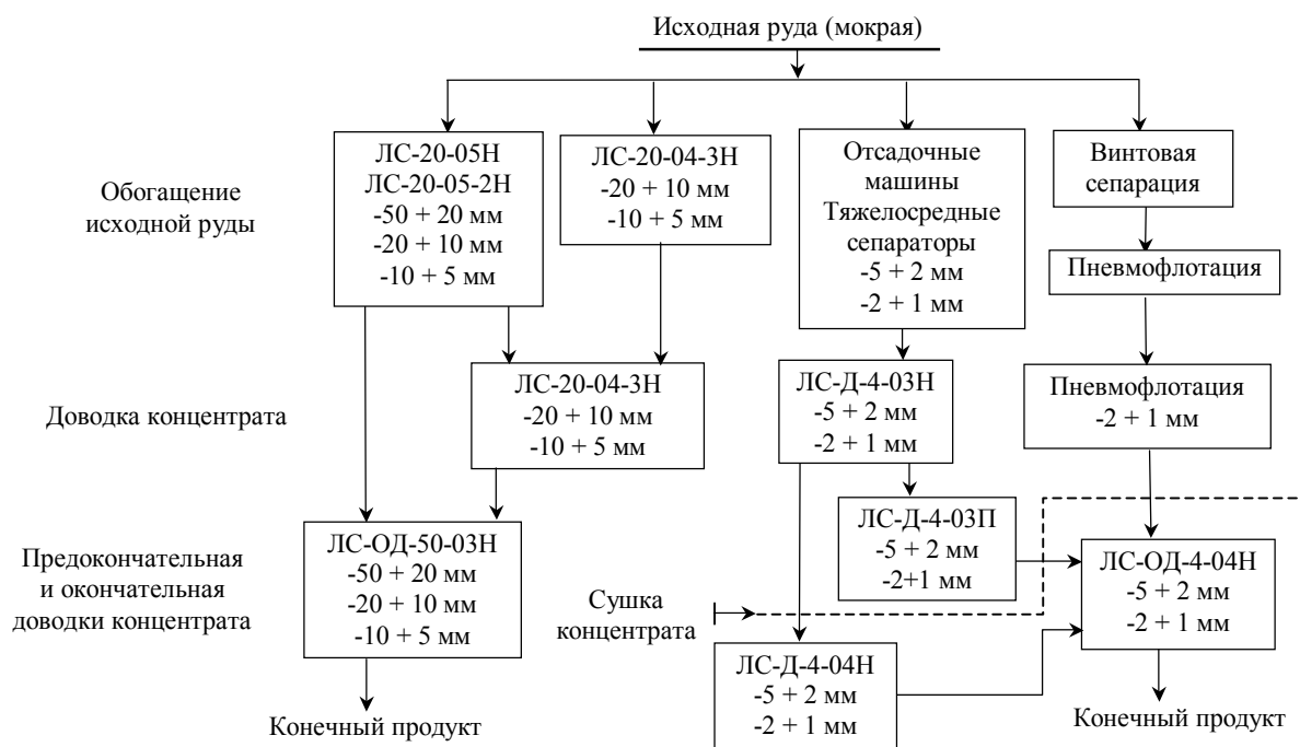
Принципиальная технологическая схема использования РЛ-сепараторов алмазного сырья
