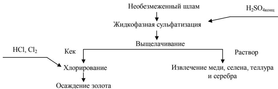
Рис.3. Принципиальная схема сульфатизационной переработки медьэлектролитных шламов
