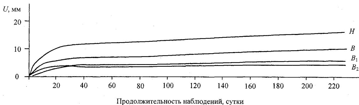
Рис. 2. Средние смещения приконтурной зоны рудного массива размером 1,8 м со стороны кровли (H), лежащего (B 1 ), висячего (B 2 ) и конвергенция боков (B) на участке экспериментальной выработки, закрепленном анкерами «Swellex»
