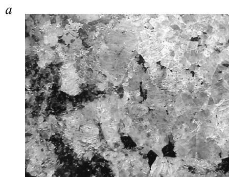
Рис.3. Вид фрагмента поверхности уртиты до (а) и после (б) взрывного нагружения
