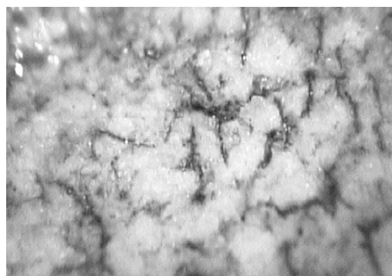
Рис.5. Следы проникновения металла ампулы сохранения в образец песчаника, подвергнутого интенсивному динамическому нагружению
