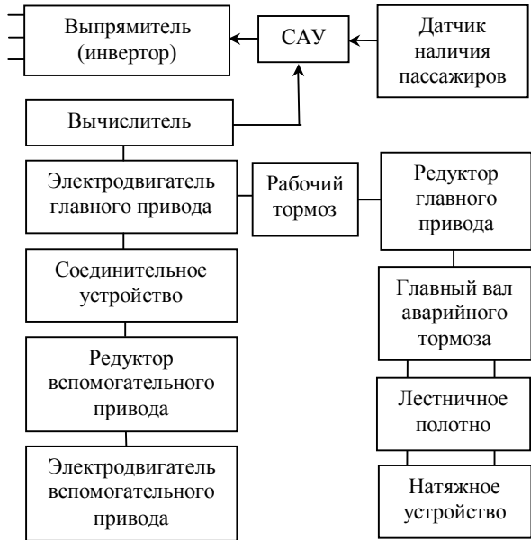
Рис.2. Функциональная схема эскалатора с регулируемым приводом
