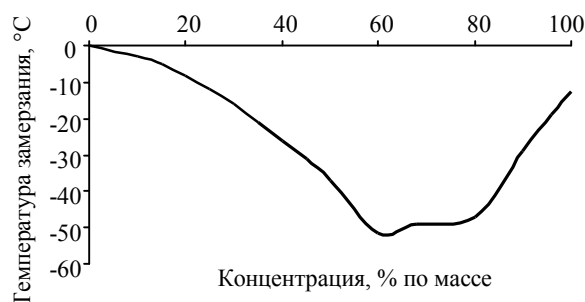
Рис.6. Зависимость температуры замерзания водного раствора этиленгликоля от его концентрации [7]
