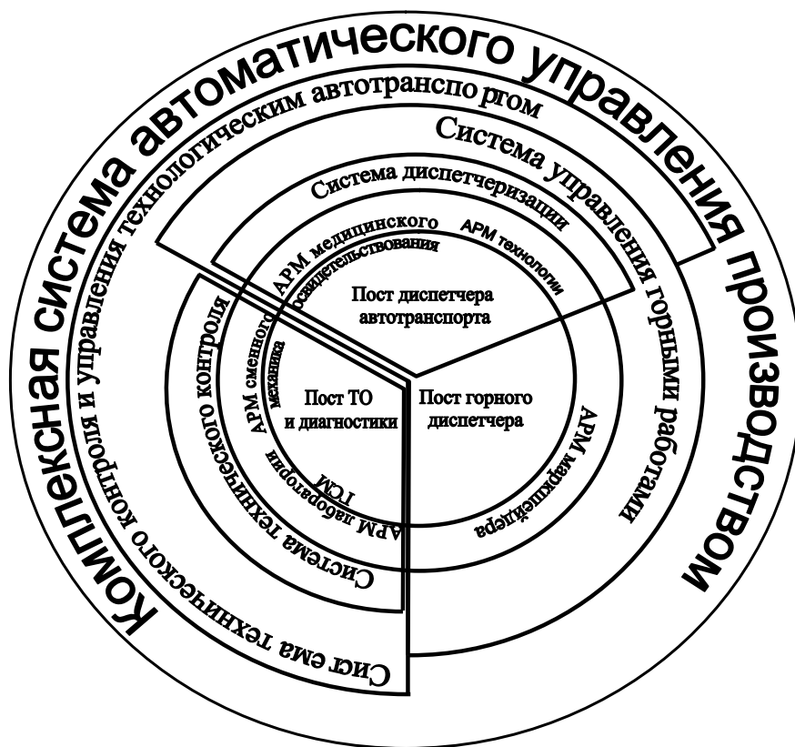
Рис.5. Структура многофункционального модуля автоматизированного управления производством
