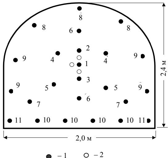
Схема шпуров для проходки выемки
