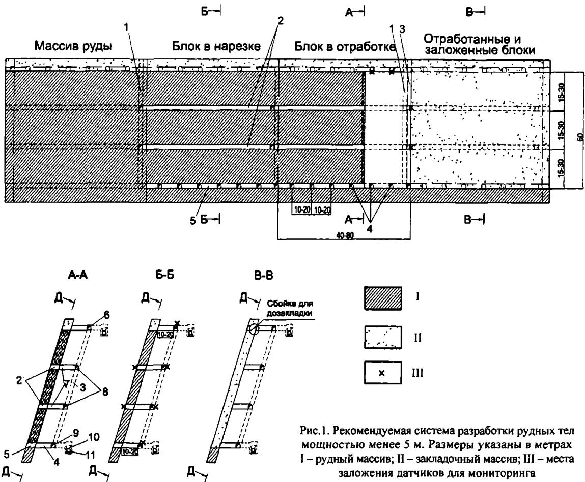
Рис.1. Рекомендуемая система разработки рудных тел мощностью менее 5 м. Размеры указаны в метрах
