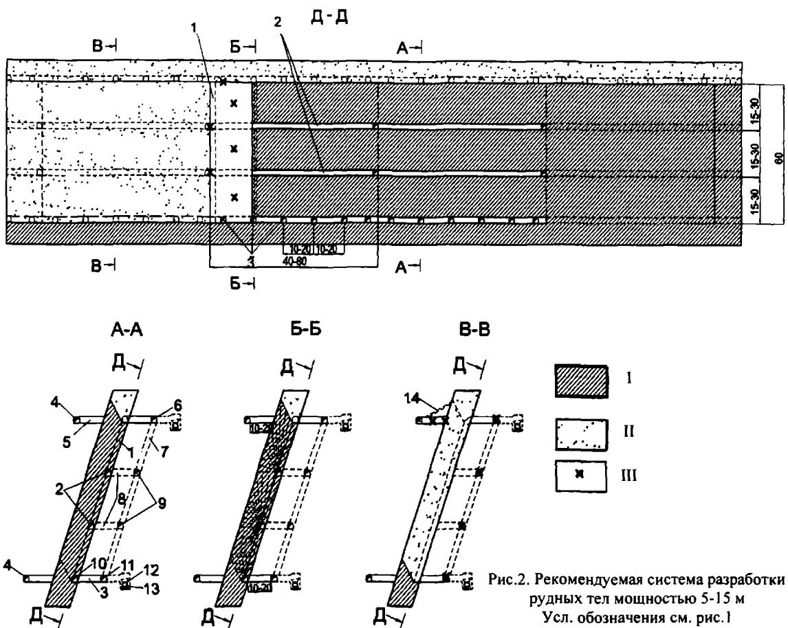
Рис.2. Рекомендуемая система разработки рудных тел мощностью 5-15 м
