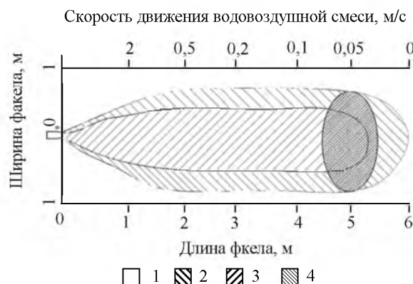
Рис. 2. Карта распределения термодинамических параметров в зоне работы пневмогидравлической форсунки 1, 2 и 3 – зоны температур; 0, -1 и -2^\circ\text{C} соответственно; 4 – зона наиболее эффективного снегообразования
