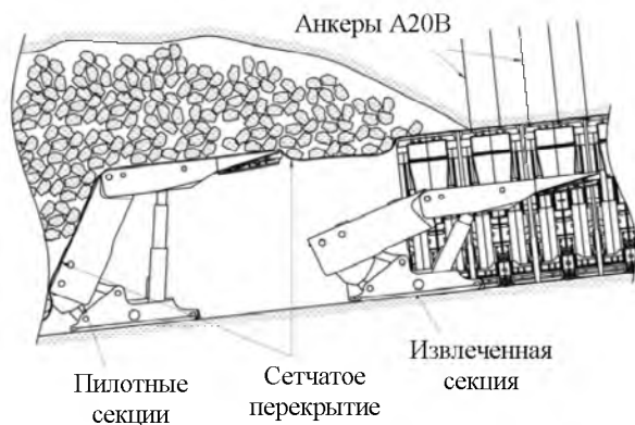
Рис.4. Схема с совместным применением полимерной сетки и пилотных секций
