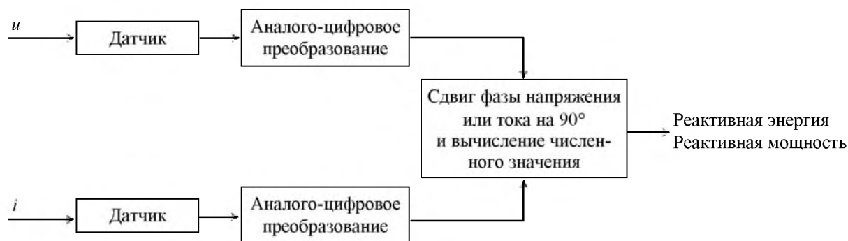
Рис. 1. Блок-схема измерения реактивной энергии путем аналого-цифрового преобразования напряжения и тока, цифрового поворота фазы напряжения или тока на 90°
