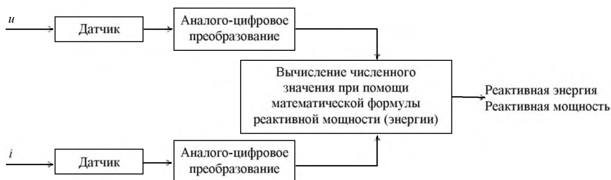
Рис. 2. Экспериментальная блок-схема измерения реактивной энергии путем аналого-цифрового преобразования напряжения и тока и последующей реализации математических формул реактивной мощности и энергии
