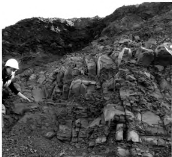
Рис.1. Борт разреза, ослабленный трещинами
