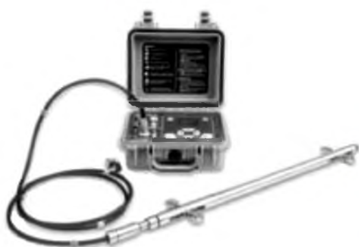
Рис.6. Инклинометрический зонд («Sisgeo», Италия)
