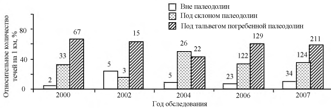
Рис.4. Количество выявленных течей в несущих конструкциях тоннелей по годам фазы затухания 23 солнечного цикла (2000-2007 гг.)
