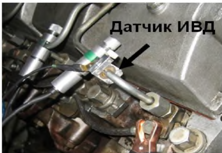
Рис.1. Установка дизельного датчика ИВД перед форсункой
