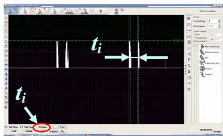
Рис.3. Измерение периода для расчета значения локальной частоты вращения КВ по одному цилиндру
