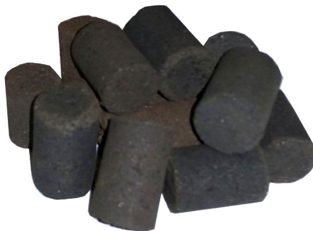
Рис.3. Экспериментальные угле-торфяные гранулы (влажность 25%)
