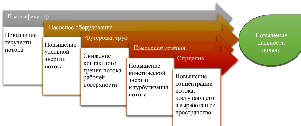
Рис.1. Способы увеличения дальности доставки гидравлической смеси
