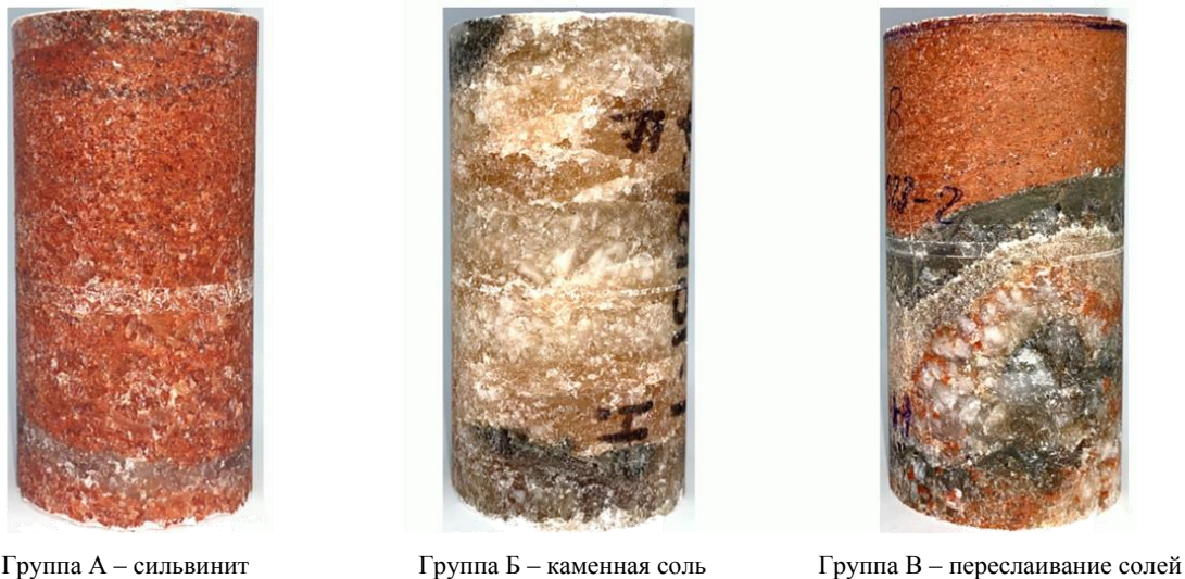
Рис.2. Типы образцов, использовавшихся для получения физико-механических характеристик
