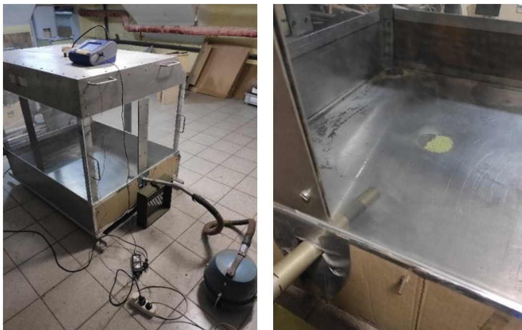
Рис.1. Лабораторная установка пылеподавления в лаборатории Горного университета
