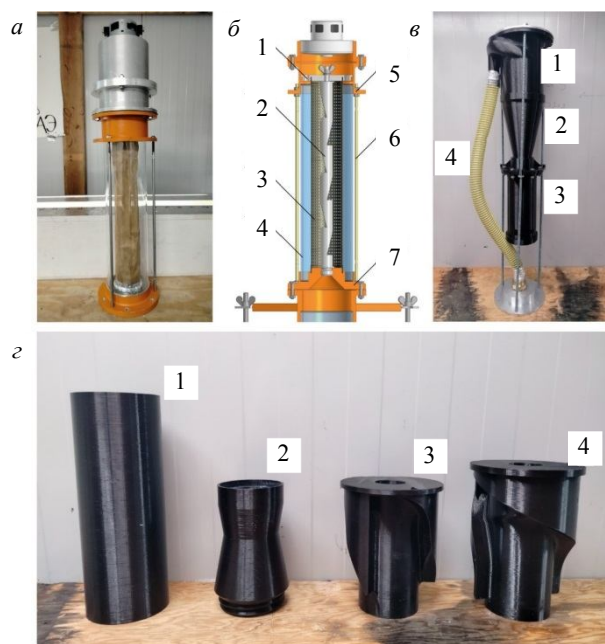
Рис.6. Конструкции шламосборных фильтров: а – общий вид верхней части экспериментального стенда перед испытаниями сетчатого шламосборного фильтра; б – сетчатый шламосборный фильтр (1 – фланец сетчатого фильтра; 2 – шламоподъемная трубка; 3 – сетчатый фильтр; 4 – прозрачная труба из оргстекла; 5 – верхний фланец; 6 – шпильки; 7 – нижний фланец); в – циклонный фильтр с одним входным патрубком (1 – цилиндрическая часть циклона с тангенсальным подводом; 2 – конусная часть циклона; 3 – шламосборный бак; 4 – шламоподъемный шланг); г – циклонный фильтр с двумя и тремя подводами (1 – шламосборный бак; 2 – конусная часть циклона; 3 – верхняя часть циклона с двумя подводами; 4 – верхняя часть циклона с тремя подводами)
