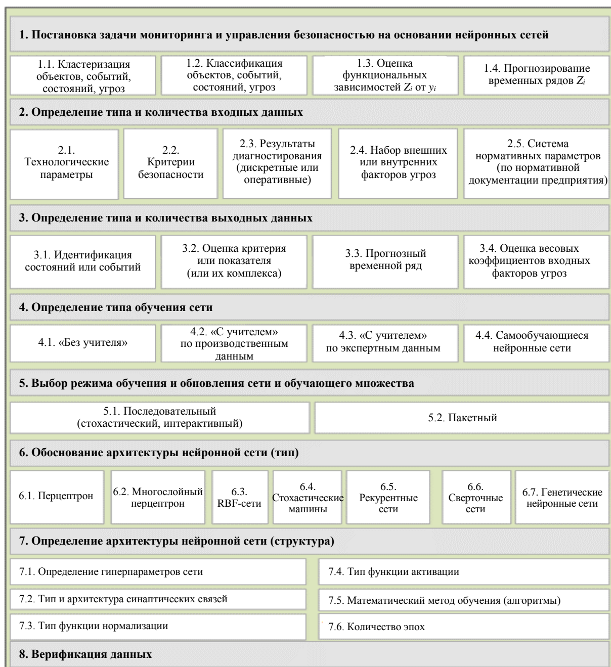
Рис.2. Алгоритм реализации методики создания нейросетевой модели для системы мониторинга безопасности объектов ( Z_i – показатель безопасности; y_i – сканируемый системой мониторинга параметр)
