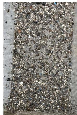
Рис.6. Фотография сетки приемной емкости с поднятым из забоя канала шламом
