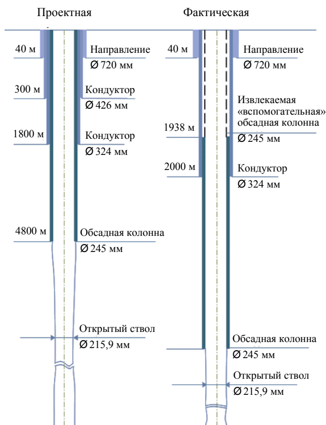
Рис.2. Конструкция Кольской сверхглубокой скважины
