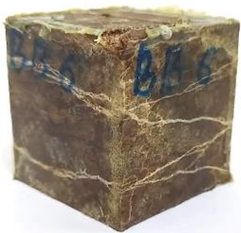
Рис.5. Результаты испытаний образца по программе «перфорационное отверстие в необсаженной скважине»: a – кривые деформирования образца; б – изменение проницаемости образца в ходе опыта; в – фотография образца после испытания
