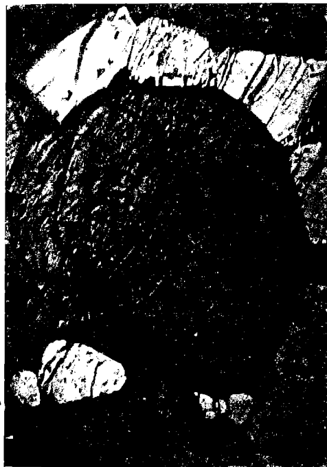
Рис. 11. Ксеноморфизм хромшпинелидовых зерен по отношению к крупному округленной формы зерну оливина, превращенного в серпентин (темносерое). \times 30
