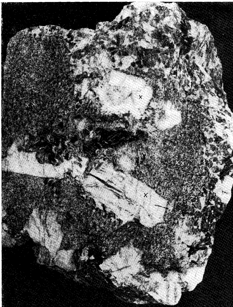
Рис. 10. Крупные бластокристаллы полевых шпатов (X) в гранитной массе (XX) пегматитовой жилы
