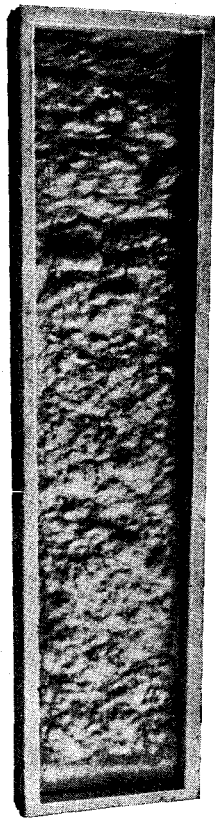
Рис. 2. Пленочный монолит из шурфа на стадионе «Спартак» в г. Волгограде. Разрез представлен моренным суглинком с валунчиками. Размеры оригинала 130 \times 27 см.
