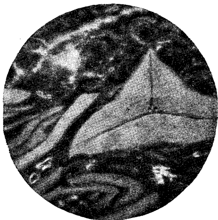
Рис. 6. Микроструктура прослойка концентрации макроспор в проходящем свете, \times 90
