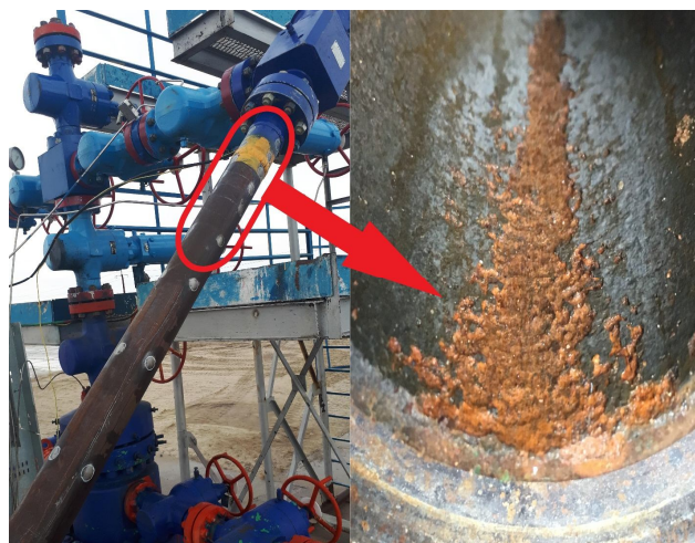
Рис.8. Демонтированный участок трубопровода и следы коррозии по нижней образующей трубопровода
